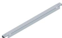
A barra de suporte de paletes é utilizada para suportar paletes de fraca qualidade ou quando as paletes são colocadas com o lado de 1200 mm voltado para o corredor. Um par de suportes de paletes laminados a frio e galvanizados é capaz de suportar uma carga até 1200 kg.
