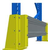
O tráfego constante em torno das estruturas nas extremidades ou no cruzamento de corredores causa frequentemente danos nas estantes. O protetor de Bastidor da stow é construído com uma viga sigma principal suportada por dois protetores de extremidades. Para comprimentos maiores, são instalados braços intermédios de suporte.
