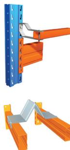
Os batentes palete podem ser utilizados em estantes simples ou duplas. São frequentemente utilizados para proteger a parede do edifício, por exemplo em armazéns refrigerados, ou para garantir o espaço entre as paletes em estantes duplas no sistema de proteção contra incêndios. A viga batente também pode ser utilizada para fixar revestimentos laterais ou rede na parte posterior de estantes.
