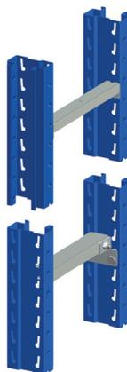
Nas estantes duplas, os separadores de bastidores são instalados entre cada par de estruturas, podendo também ser utilizados para fixar o aspersor do sistema de proteção contra incêndios.
