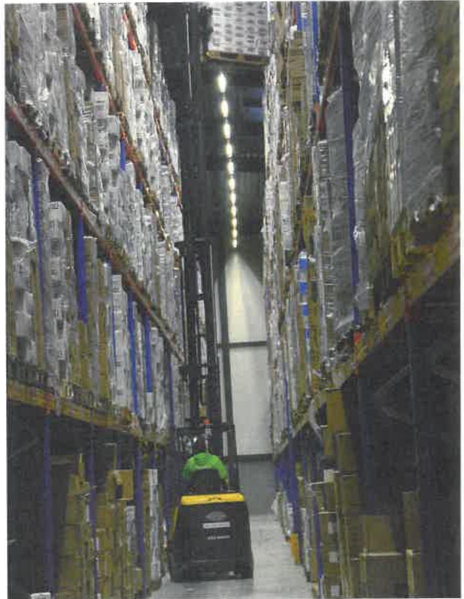
Voor het naar boven en beneden brengen van pallets zorgen de twee Aisle Masters. In het magazijn zetten de Aisle Masters pallets tot 8,5m in de rekken. De trucks kunnen allebei 2 ton heffen. In beide trucks werd een camera in de mast geïntegreerd om steeds een optimaal zicht op de last te hebben.
