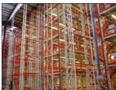
Triediace pracoviská konštruované medzi paletovým regálovým systémom
