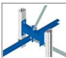
Vertikal- und Längsverbände gewährleisten die Einhaltung der geforderten Toleranzen (FEM 9.832).
