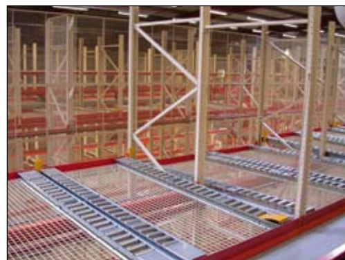
Grillage antichute entre pistes de rouleaux. Séparateur de palettes avec mécanisme de libération manuel
