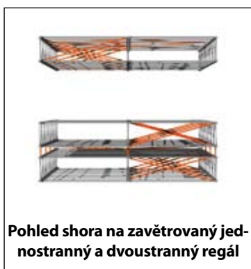
Vertikální zavětrování je přišroubované k tuhým spojníkům mezi rámy.
